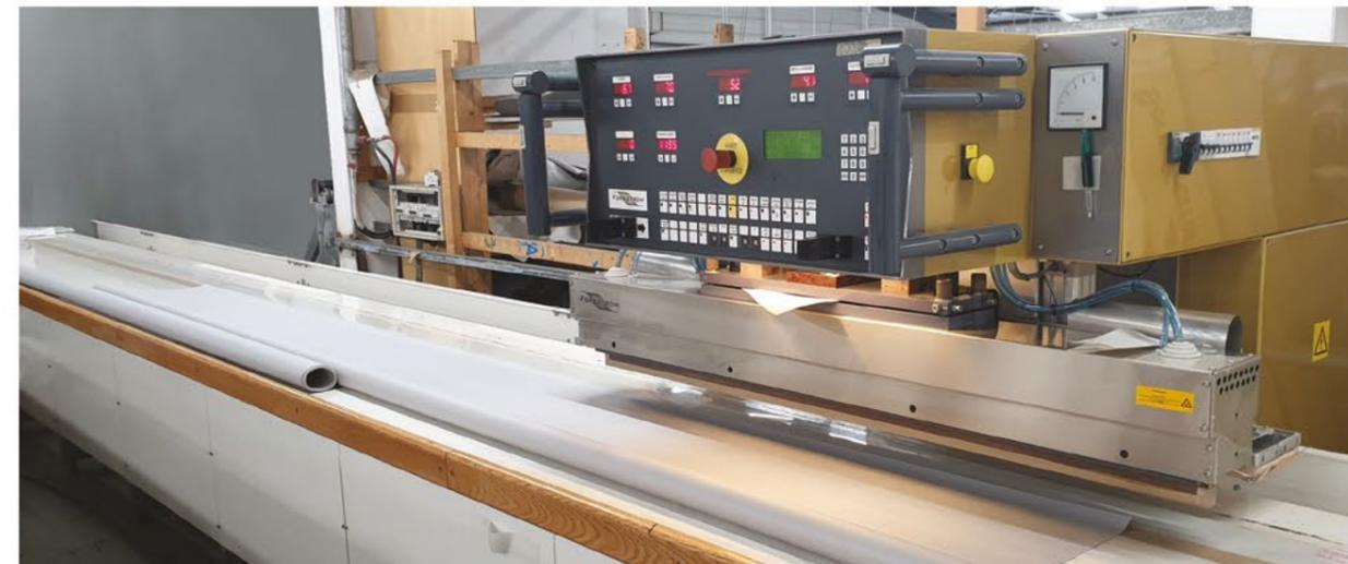
Robot de soudure haute fréquence
