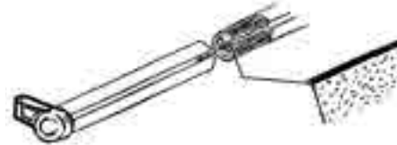
Assemblage de la toile sur le tube d'enroulement
