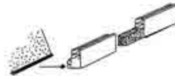
Assemblage de la barre de charge
